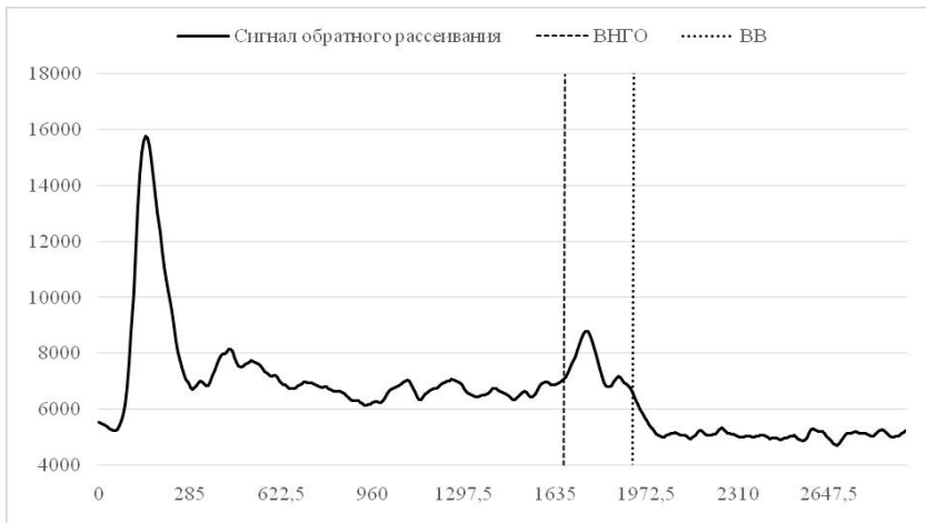
Рис. 5. – Пример работы алгоритма определения ВНГО при наличии частиц, несущественно снижающих вертикальную видимость (ВВ)
